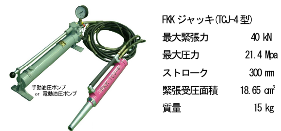
図-9 緊張ジャッキ・ポンプ
